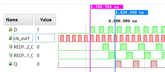
FIGURE 4 – Simulation du synchroniseur montrant la stabilisation de la sortie
